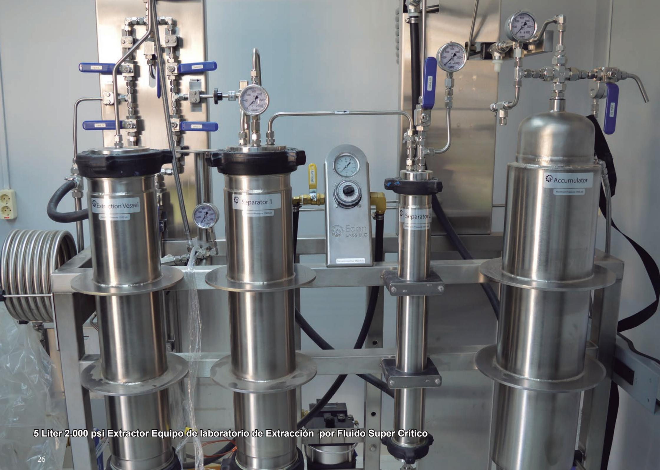
5 Liter 2.000 psi Extractor Equipo de laboratorio de Extracción por Fluido Super Crítico
